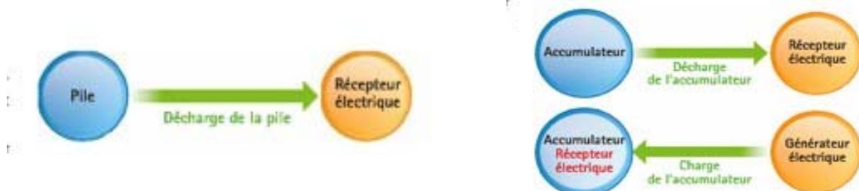
Un accumulateur est une pile que l'on peut recharger en régénérant les réactifs : pour cela on « force » la réaction inverse de la réaction de fonctionnement de la pile en apportant de l'énergie électrique à l'aide d'un générateur. Cette opération se nomme **électrolyse**.
