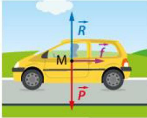
Toutes les forces qui s'appliquent sur la voiture sont représentées en son centre de masse  $M$  sans souci d'échelle. Le poids  $\vec{P}$  du véhicule et la réaction  $\vec{R}$  de la route sur les pneus se compensent. La valeur de la force de frottement est  $f = 300 \text{ N}$
